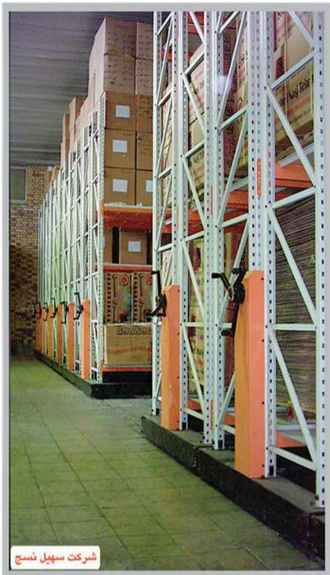
این سیستم به دلیل برخورداری از مزایای سیستم سنگین متحرک و عدم وجود محدودیت در چیدمان، توانایی لازم برای بهره برداری بهینه از فضا و صرفه جویی در هزینه های عمومی را دارا می باشد.
